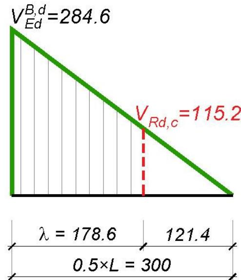
U tački 2.3.2. je pokazano da je na čitavoj dužini osiguranja potrebno postaviti barem trosečne uzengije radi zadovoljenja maksimalnog poprečnog rastojanja uzengija  $s_{t,max}$ , nezavisno od prečnika usvojene armature. Usvajajući trosečnu uzengiju Ø10 sledi:
