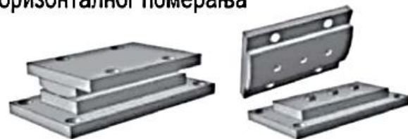
Линијско лежиште које омогућава ротацију (без хоризонталног померања)
