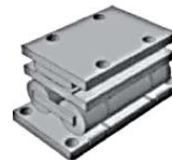
Лежиште које омогућава и ротацију и хоризонтално померање
