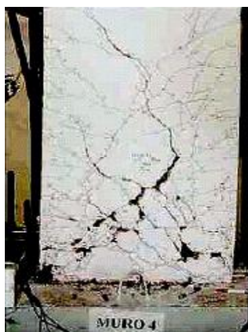
Slika 3.31 - Slika prslina u uklještenu zida nakon cikličnog opita i histerezisni dijagram
