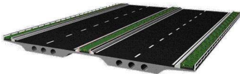
Типични 3д рендер плочастог моста са ошупљеним попречним пресеком (Díaz et al., 2010)
