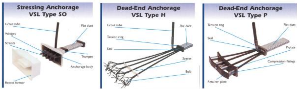
Slika 1.22 Kotve kablova bez spoja za prethodno napreznje ploča (VSL International)
