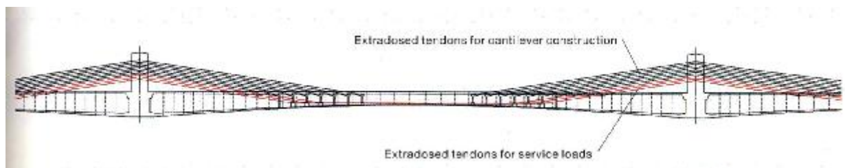
Slika 1.39 Spoljašnje prethodno naprezanje mosta
