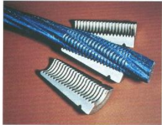
Slika 1.17 Uže i rasklopljeni trodelni klin
